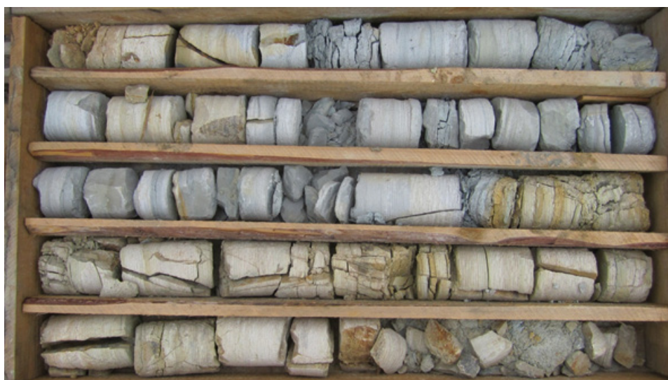
Рис. 5. Распространение гидроксидов железа по тектоническим трещинам и слоям глинистых доломитов в кровельной части холомолохской свиты верхнего кембрия. Фрагмент разреза по керну по скважине № 66.2-116.4, интервал 90–94 м
