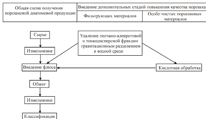
Рис. 7. Принципиальная схема получения порошковой продукции из диатомитов на примере Забалуйского и Атемарского месторождений. Составлена по разработкам О.М.Мдивнишвили (КИМС) и Т.П.Конюховой (ЦНИИГеолнеруд)
