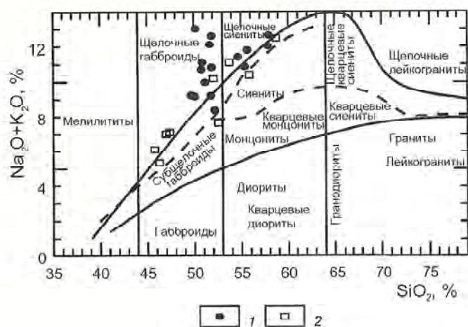
Рис. 4. Положение точек силикатных щелочно-основных пород Халютинского комплекса на классификационной диаграмме (\text{Na}_2\text{O}+\text{K}_2\text{O})-\text{SiO}_2 [5]:
