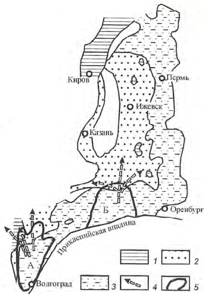
Рис. 4. Пример реставрации направлений движения термодегидратационных вод по породам-коллекторам пашийского горизонта D_4 по материалам Ш.В.Абашева и др., 1978:
