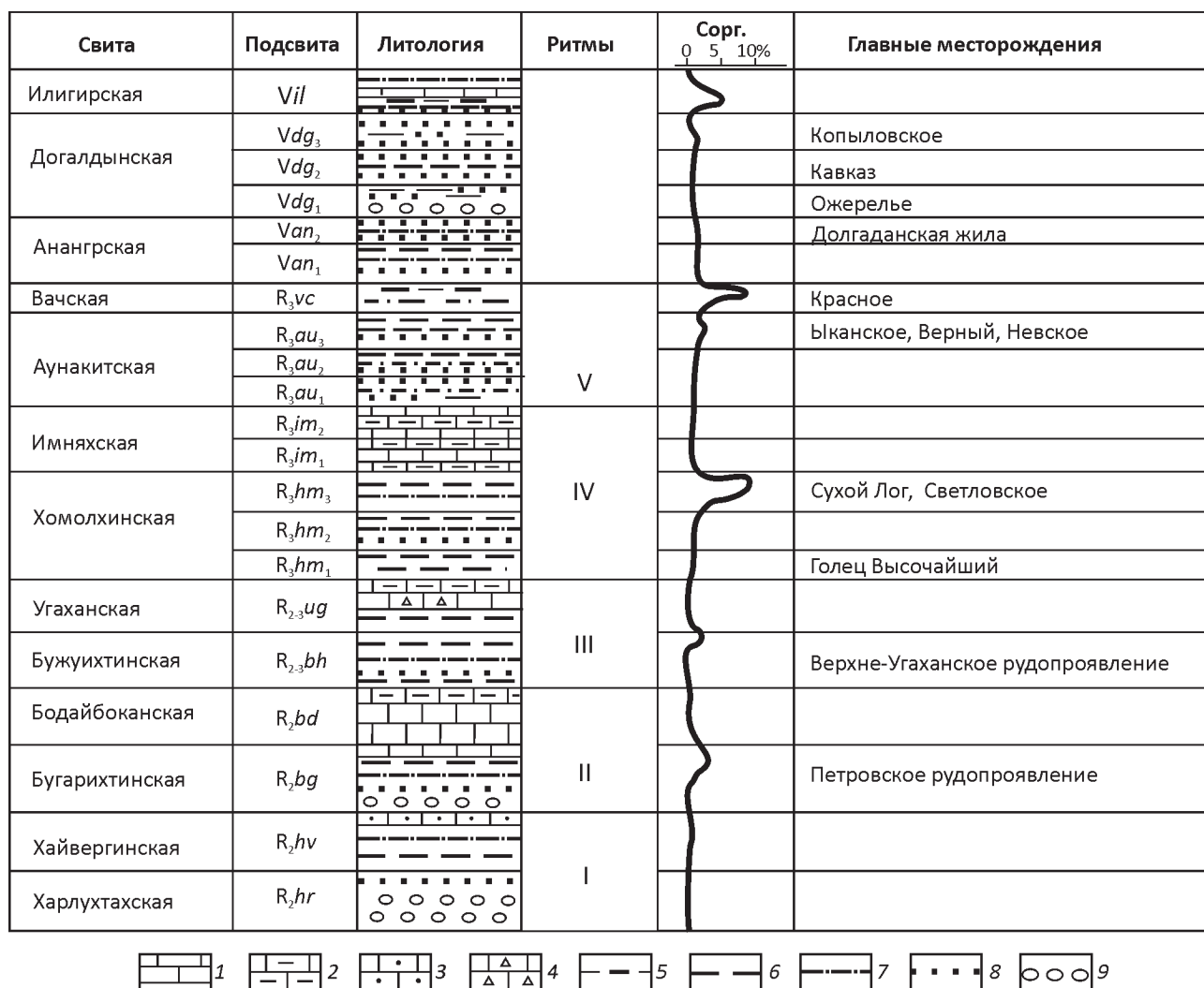
Рис. 1. Позиция золоторудных месторождений в ритмах рифей-вендской флишеидной толщи Байкало-Патома. На основе материалов [9, 13]:
