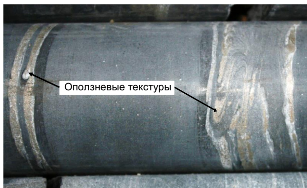
Рис. 4. Оползневые складки в существенно сульфидных слойках (жёлтые «блестящие»), сложенных пирротином. Месторождение Угаханское, бужуйхтинская свита, скв. 8, инт. 109,8 м
