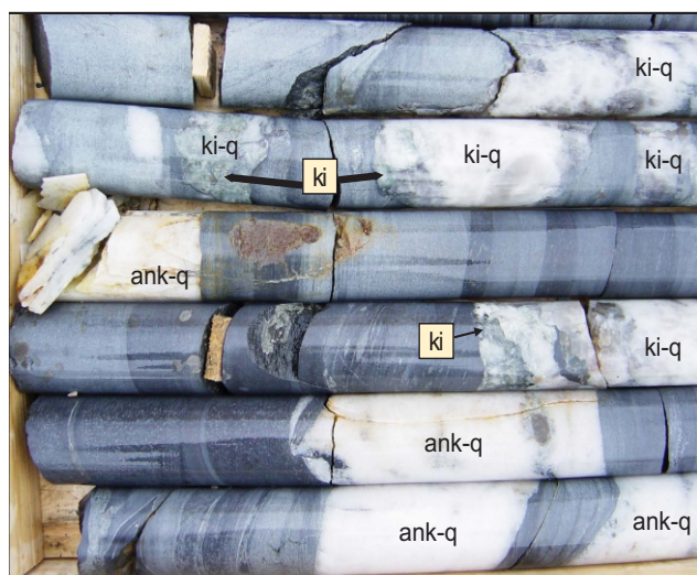
Рис. 19. Кианит-кварцевые (ki-q) синрегионально-метаморфические и анкерит-кварцевые рудные (ank-q) жилы в Рудной зоне № 1 месторождения Ожерелье (скв. 4). Диаметр керн 63 мм
