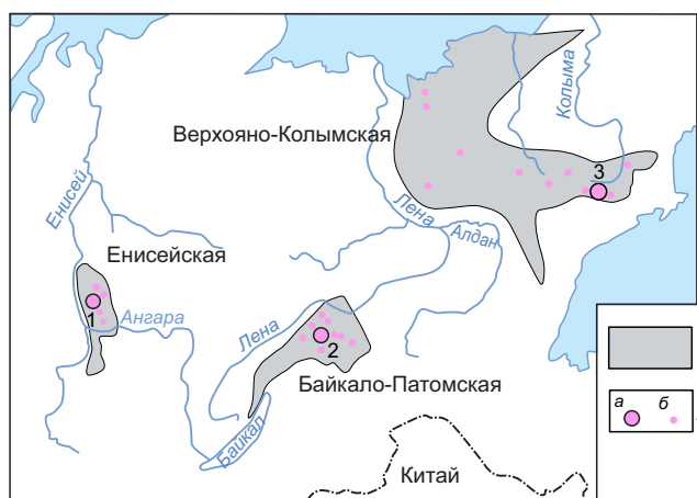
Рис. 1. Схема расположения Енисейской, Байкало-Патомской и Верхояно-Колымской металлогенических провинций с золоторудными месторождениями в терригенных и карбонатно-терригенных углеродистых формациях («черносланцевых толщах»):
