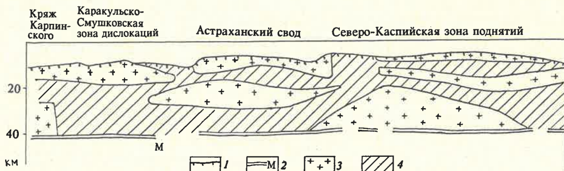
Рис. 2. Глубинный геоэлектрический разрез Прикаспийской впадины, составил И.А.Яковлев по материалам центра Геон и ГГП «Спецгеофизика»:
