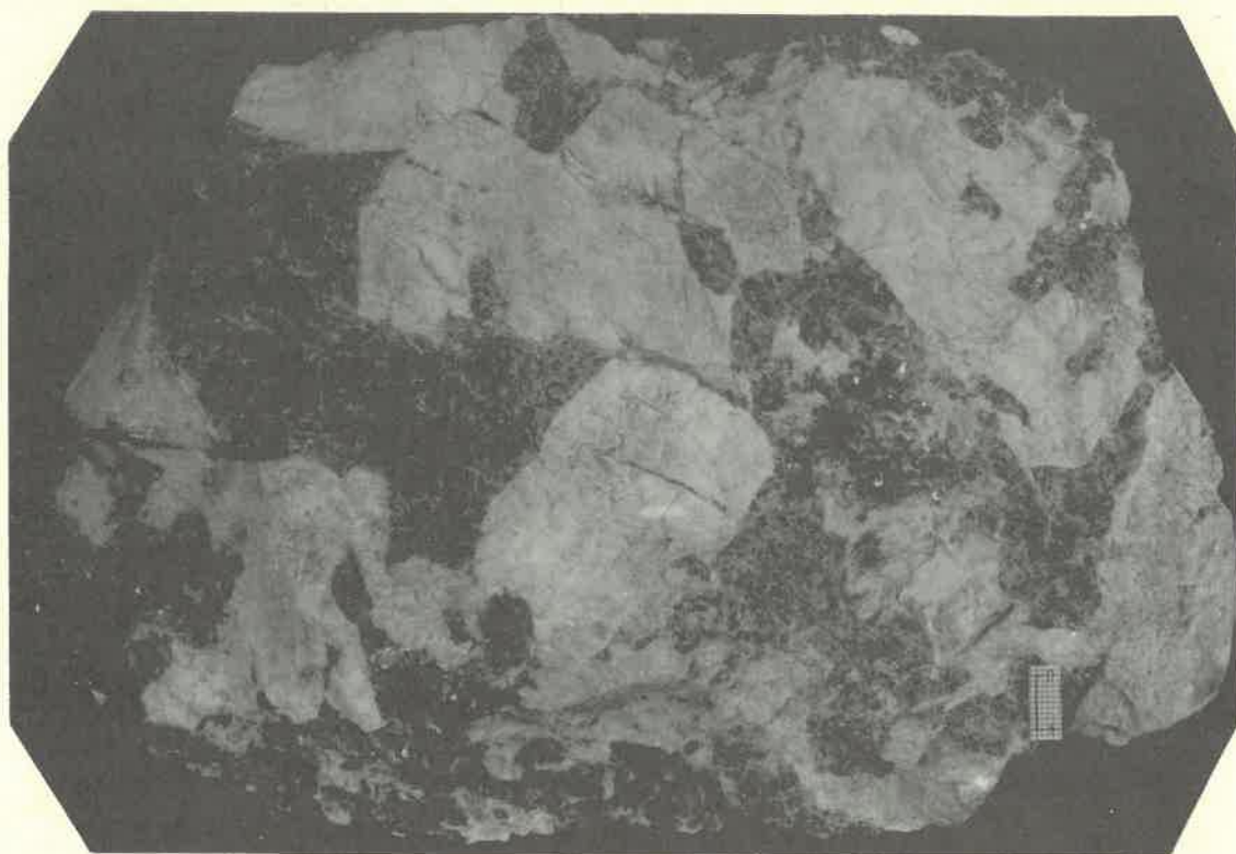
Рис. 10. Пегматоидная (гранитная) структура пегматита, сложенная разноориентированными изометричными кристаллами полевого шпата и кварца в участково-зональных жилах:
