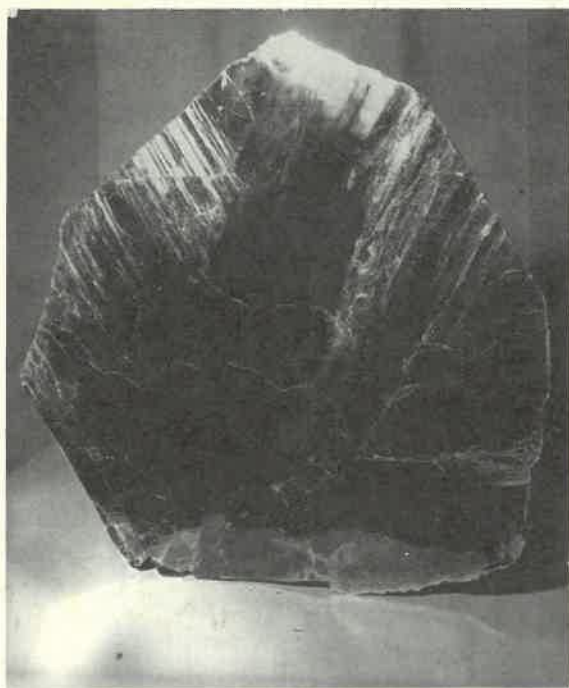
Рис. 6. Скелетный кристалл мусковита с дефектами строения (ельчатость) в средней части граней
