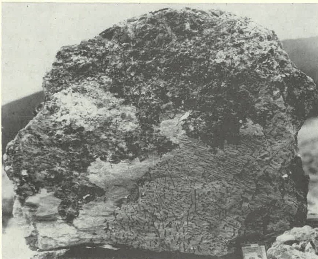
Рис. 8. Зональный кристалл микроклина с ихтиоглинтами кварца в центральной части, замещается кварц-мусковитовой ассоциацией
