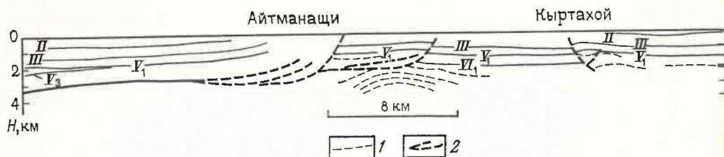
Рис. 2. Сейсмогеологический разрез, иллюстрирующий надвиговую природу антиклинальных зон Восточного Мангышлака:
