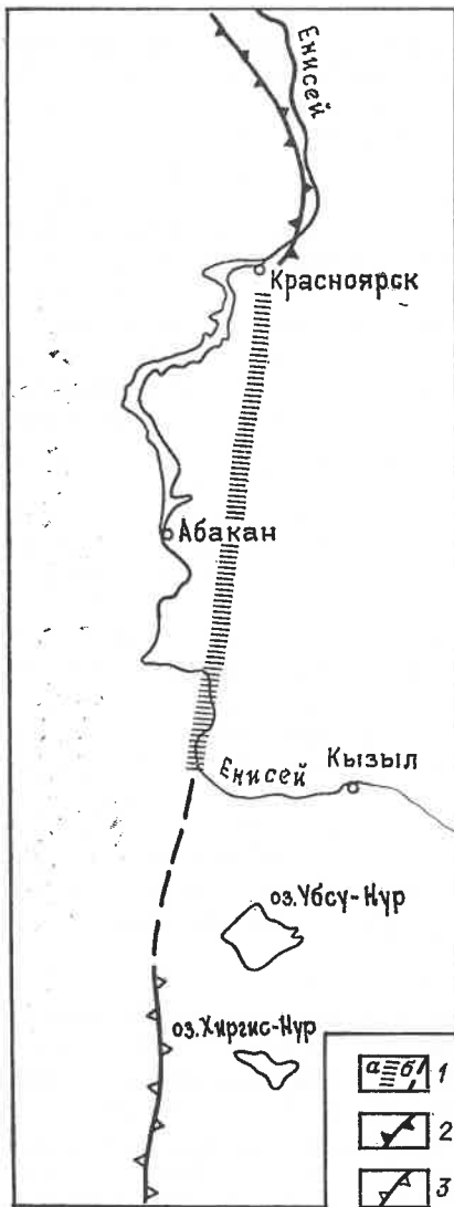
Рис. 4. Схема сочленения Саяно-Енисейского сквозного разлома с разрывными структурами за пределами центральной части Алтае-Саянской области: 1 — зона Саяно-Енисейского сквозного разлома (а) и предполагаемое его продолжение (б); 2 — главная Приенисейская зона разломов, по О. А. Вотаху; 3 — зона Кузнецко-Алтайского разлома, по О. Г. Жеро и Л. В. Смирнову
