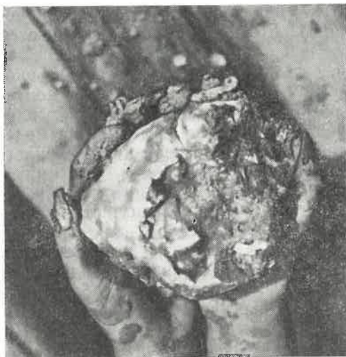
Рис. 3. Штупф почти мономинерального газового гидрата. Фото М. Н. Григорьева
