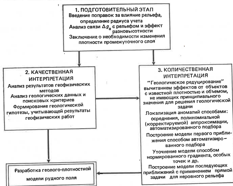
Рис. 1. Технологическая схема интерпретации материала крупно-масштабной гравиразведки
