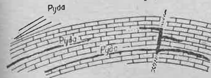
Фиг. 7. Вертикальный разрез рудника Хопе близ Филлипсбурга, Монтана. Утолщение оруденения в гребне антиклинала
