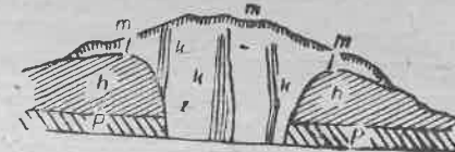
Фиг. 2. Схематическое изображение жильного золото-серебряного оруденения дацита, заполняющего кратерное жерло (размытый вулкан третичного периода). Нагиаг — три комплекса вертикально падающих параллельных между собой жил + свежий дацит, Z и K измененный (пропилитизированный и каолинизированный под действием гидротерм). Изверженные породы внедрены в осадочную толщу
