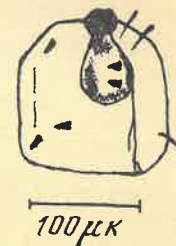
Рис. 1. Треки от осколков деления ^{235}\text{U} в газово-жидком включении в кварце из гранит-порфира. Треки клиновидной формы приурочены как к жидкой, так и к газовой фазе включения. Детектор флогопит
