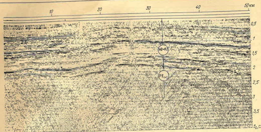
Рис. 3. Сейсмический разрез МОГТ 11, Новопортовское поднятие
