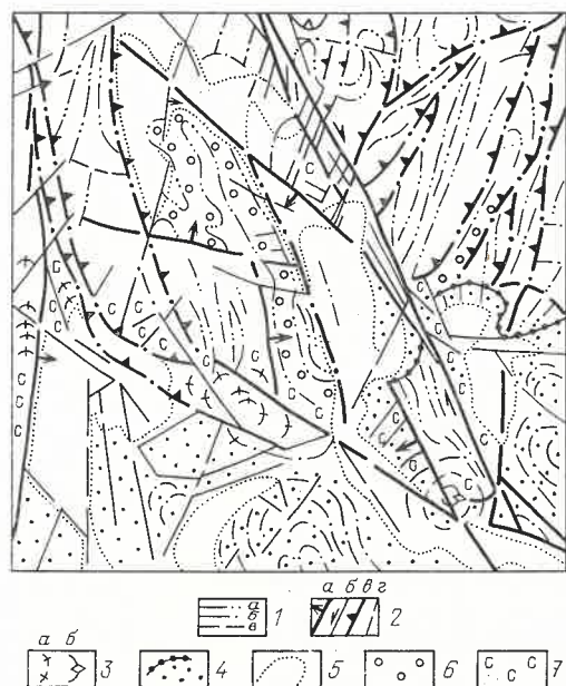
Рис. 2. Схема структурного дешифрирования 1 — структурные парагенезисы (а — раннескладчатый, б — позднекладчатый, в — посткладчатый); 2 — разрывные нарушения (а — сбросы, б — сдвиги, в — взбросо-надвиги, г — неклассифицированные); 3 — локальные кольцевые структуры (а — связанные с гранитами, б — трещинно-сколовые с окварцеванием в центре); 4 — среднепалеозойские вулканогенно-осадочные отложения в обрамлении горст-антиклиналей; 5 — граница участков сплошного развития четвертичных отложений; 6 — черносланцевая ордовикская формация; 7 — зоны скарирования, окварцевания, ожелезнения с проявлениями полиметаллов, железа, меди и молибдена
