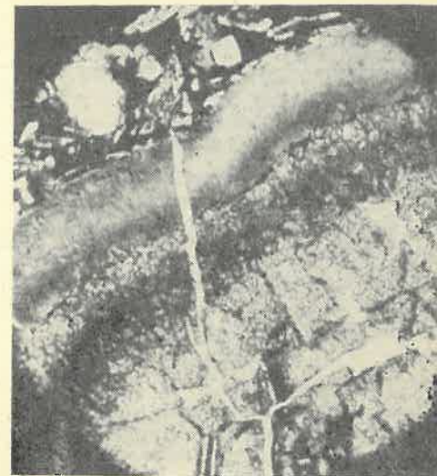
Рис. 2. Зональное строение крупной миндалины в базальте, выполненной хлорофентом Ув. 220, без анализатора
