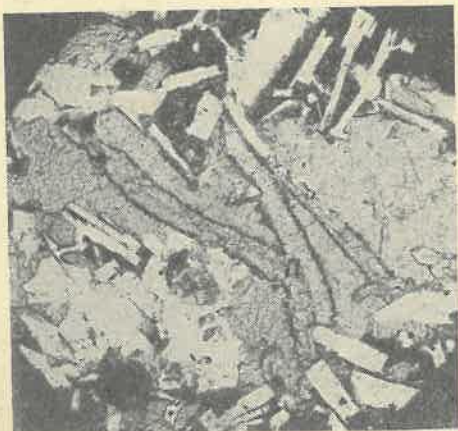
Рис. 1. Хлорофент, рассеченный карбонатным прожилком (1), в основной массе базальта Ув. 90, без анализатора
