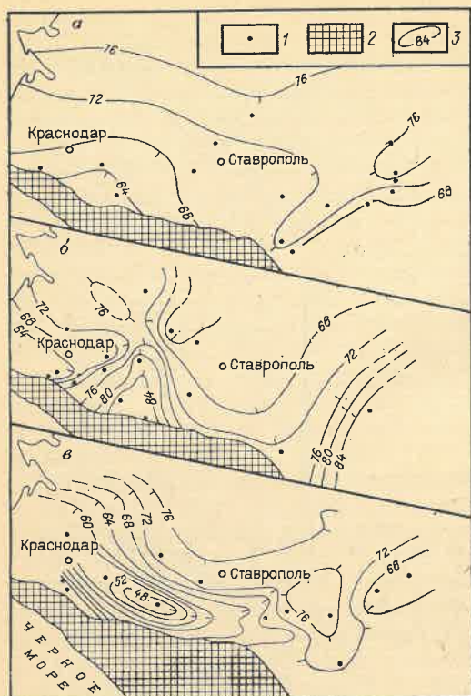
Рис. 3. Схемы содержания гидрослюда Свиты: а — белоглинская, б — черкесская; в — лабинская 1 — скважины, по которым изучены глинистые минералы; 2 — выходы на дневную поверхность доэоценовых пород; 3 — изолинии процентного содержания (от содержания монтмориллонита и смешанослойных минералов)
