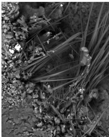
Рис. 3. Морфология кристаллов вилкоксита, месторождение Бом-Горхон (А) и галотрихита, месторождение Озерное (Б). Изображения получены на сканирующем электронном микроскопе (СЭМ)
