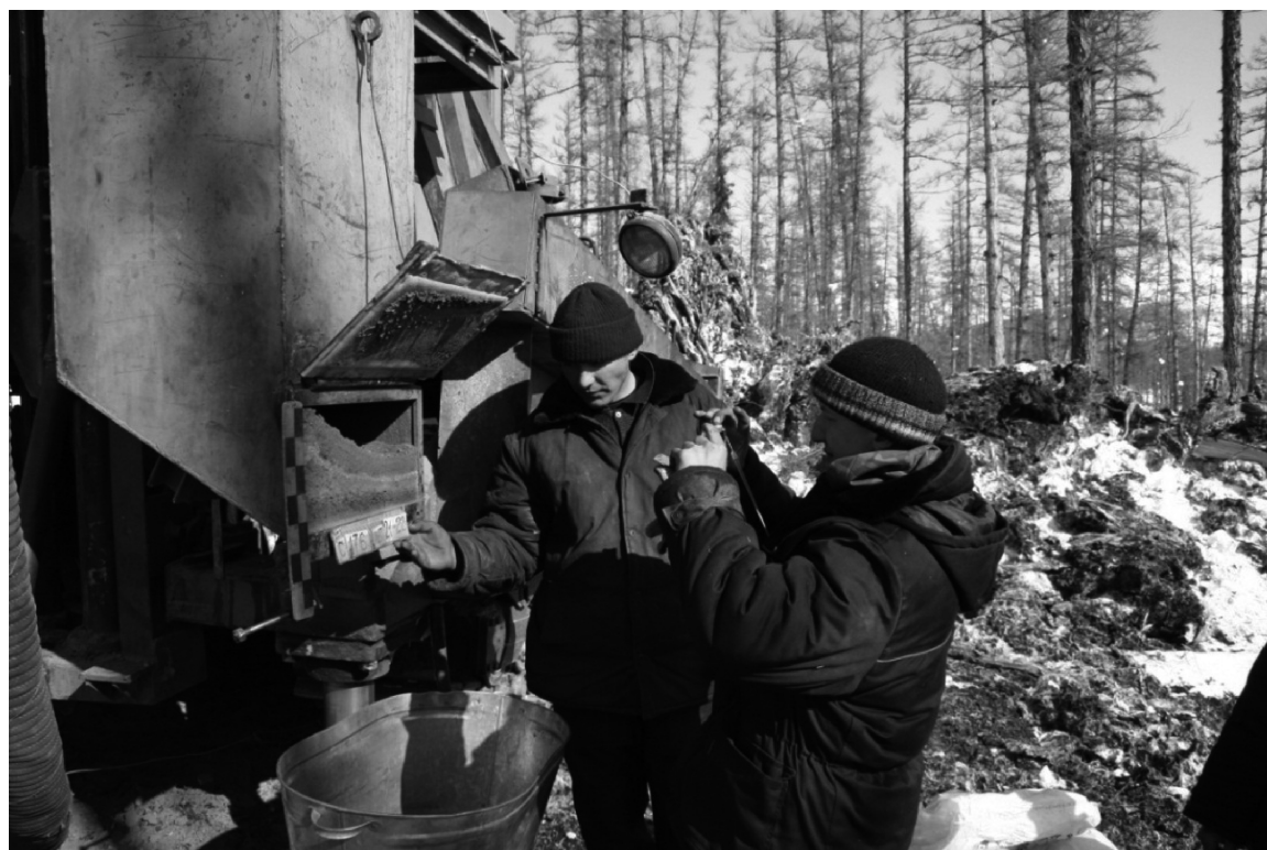
Рис. 6. Фотодокументация однометрового интервала пневмоударного бурения в приемном бункере
