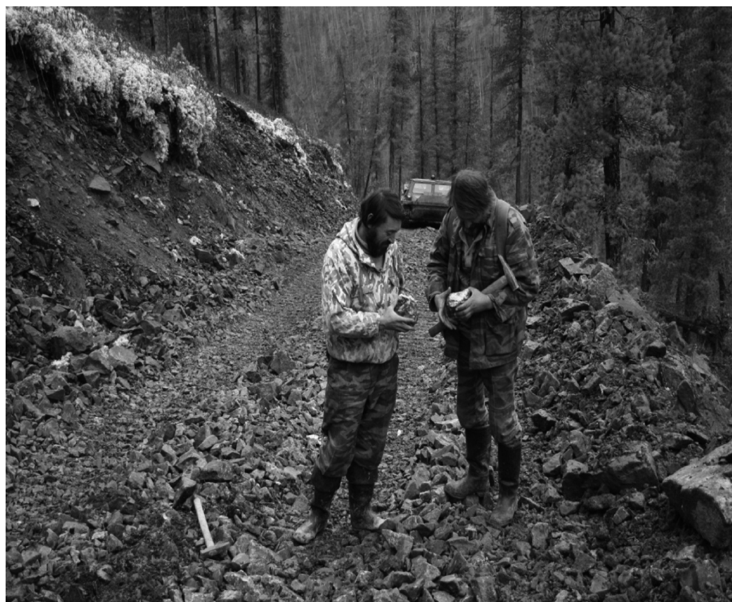
Рис. 5. Выявление перекрытых курумником рудных свалов в делювии при документации бульдозерной канавы глубиной до 1 м (Аройское рудное поле)
