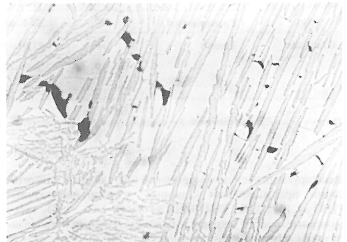
Рис. 1. Самородный марганец (светло-серый) с пластинчатыми выделениями карбида марганца (темно-серые):
