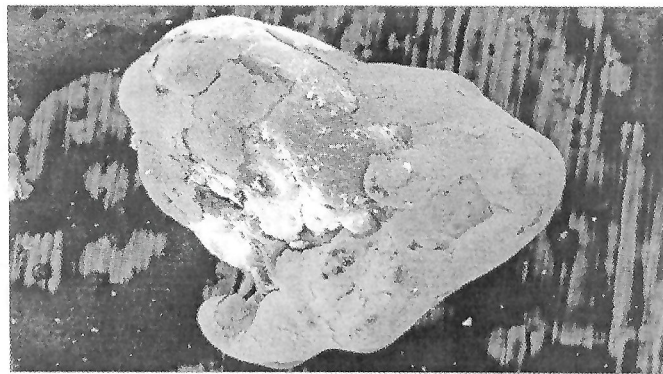
Рис. 3. Золотина в сростке с кварцем, окатанная воздушно-песчаным потоком в экспериментальной установке, \times 54
