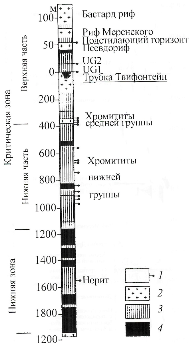
Рис. 3. Стратиграфическая колонка нижней части Бушвельдского магматического комплекса и место нахождения в ней трубки Твифонтейн [7]:
