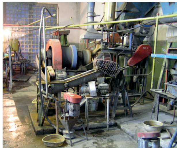
Рис. 2. Общий вид установки ОАО «Тулское НИГП», используемой для полупромышленного гравитационного обогащения 41 ЛТП. Фото автора
