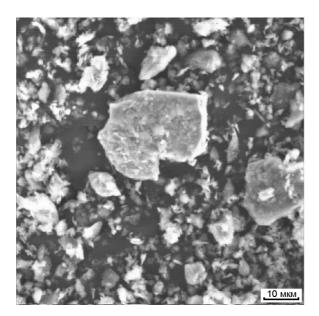
Рис. 5. Продукт 1 с измененными зернами пирита, из которых в процессе биоокисления вынесена сера
