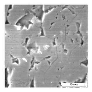
Рис. 2. Трещиновато-пористая структура арсенопирита с включениями золота (содержание Au от долей до первых процентов)
