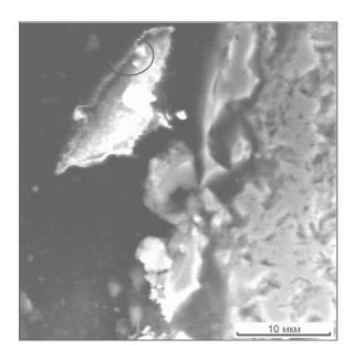
Рис. 3. Повышенная золотоносность мелких зерен арсенопирита (слева) по сравнению с крупными (справа) в брикете из флотационного концентрата
