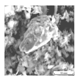
Рис. 8. Зерно золотоносного пирита, слабо измененное морфологически и по составу (в центре) после 80-часового биовыщелачивания
