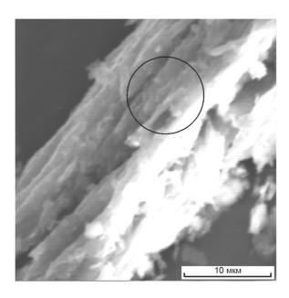
Рис. 14. Силикатсодержащий агрегат с углистым дендритом из продукта 6
