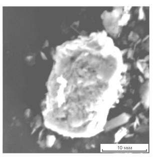
Рис. 12. Зерно пирита, интенсивно выщелоченное в центре, из продукта 6 после 60-часового биоокисления концентрата и солянокислой обработки
