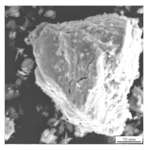
Рис. 10. Флотационный концентрат, слабо измененный в процессе кислотной обработки без применения бактерий
