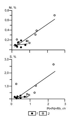
Рис. 6. Соотношение элементов платиновой группы с никелем и серой в породах восточной части пласта «330»:
