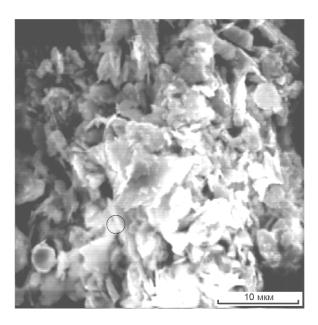
Рис. 13. Силикатсодержащий агрегат с незначительным количеством золота из продукта 6
