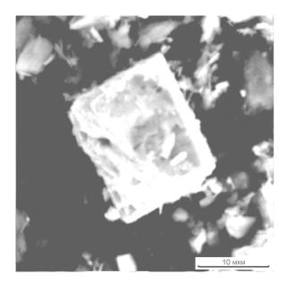
Рис. 11. Частично окисленное, кавернозное зерно пирита, поверхность которого обогащена золотом, из продукта 5 после 40-часового биоокисления и солянокислой обработки
